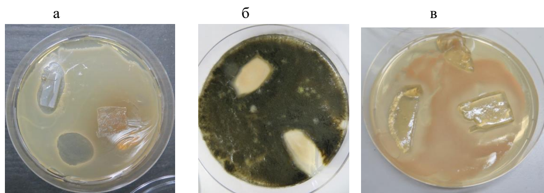
Рис. 2. Чашки Петри, засеянные бактериями Bacillus subtilis (а), грибами Penicillium chrysogenum (б) и дрожжами Rhodotorula sp.(в) с нанесенными на газоны пленками из хитозана: а – видна полностью заросшая бактериями контрольная пленка без НЧ серебра; б – пленки на поверхности с выросшим мицелием грибов; в – пленки с НЧ серебра на поверхности чашки Петри, засеянной дрожжами
