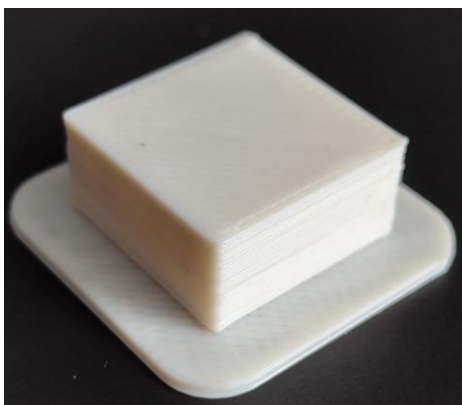
Рис 1. Фотография тестового образца хитозан:гидроксиапатит:полилактид, напечатанного методом FDM, температура 220°C
