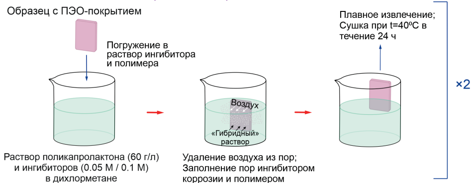
Рис. 3.1. Схема процессов формирования различных типов исследуемых покрытий
