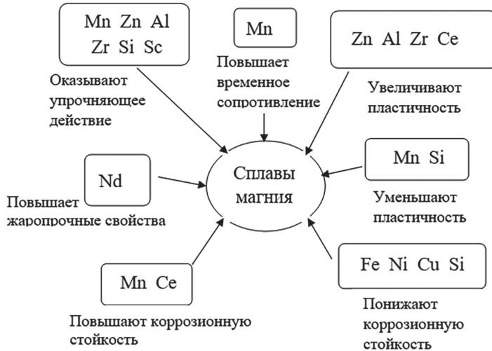
Рис. 2.9. Влияние легирующих элементов на свойства магниевых сплавов
