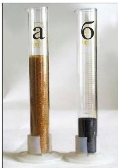
Рисунок 5 – Ионообменная смола (а) и продукт её пиролиза при 500 °С (б); адаптировано по [46]
