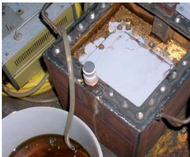
Рисунок 4 – Включение ОИОС в полимерное связующее в контейнере для захоронения [2]
