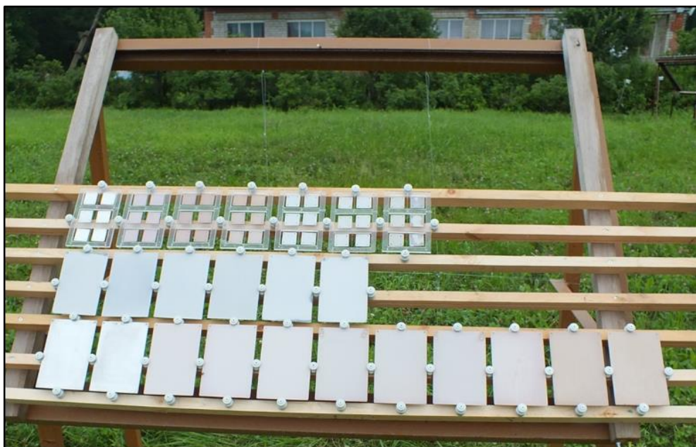
Рисунок 2.4 – Стенд с образцами для проведения климатических испытаний
