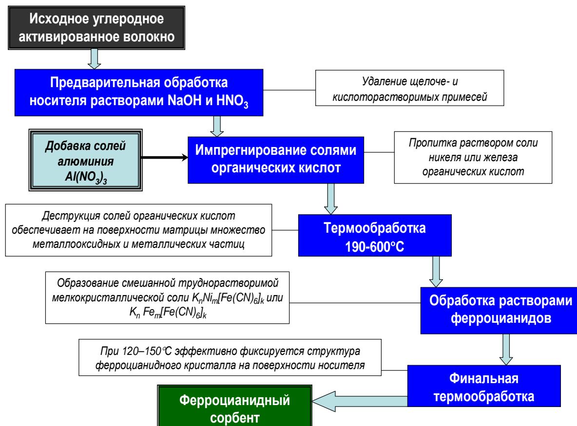
Рис. 1. Схема синтеза ферроцианидных сорбентов
