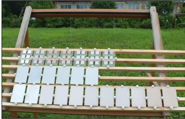
Рисунок 4.20 – Стенд с образцами для проведения климатических испытаний
