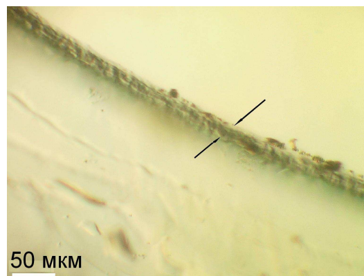
Рис. 2. ОМ микрофотография поперечного среза пленки. Условия ЭП: состав №1, E_k = -1,16 В, \tau = 10 мин. Стрелками выделен прикатодный (селективный) слой.
