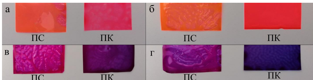
Рисунок 44 - Фотографии при дневном свете ПС и ПК пленок МПР , допированных соединениями 10 (а), 11 (б), 12 (в) и 13 (г) (концентрация 0.2 %)
