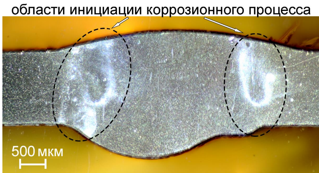
Рисунок 6.37 – Оптическое изображение образца после 1,5 ч выдержки в 3 % растворе NaCl.
