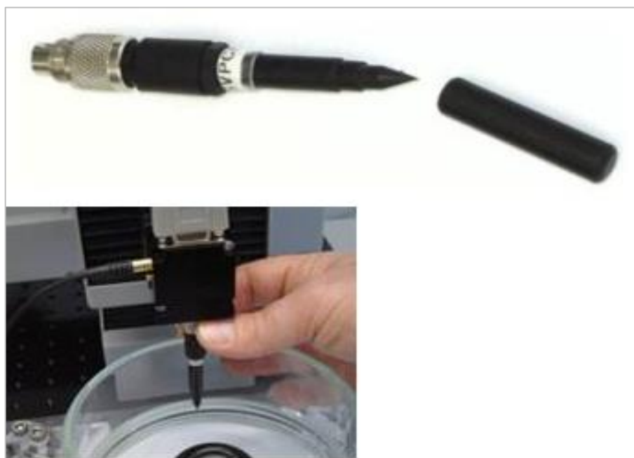
Рисунок 2.4 – Сканирующий вибрирующий зонд, используемый в электрохимической станции M370
