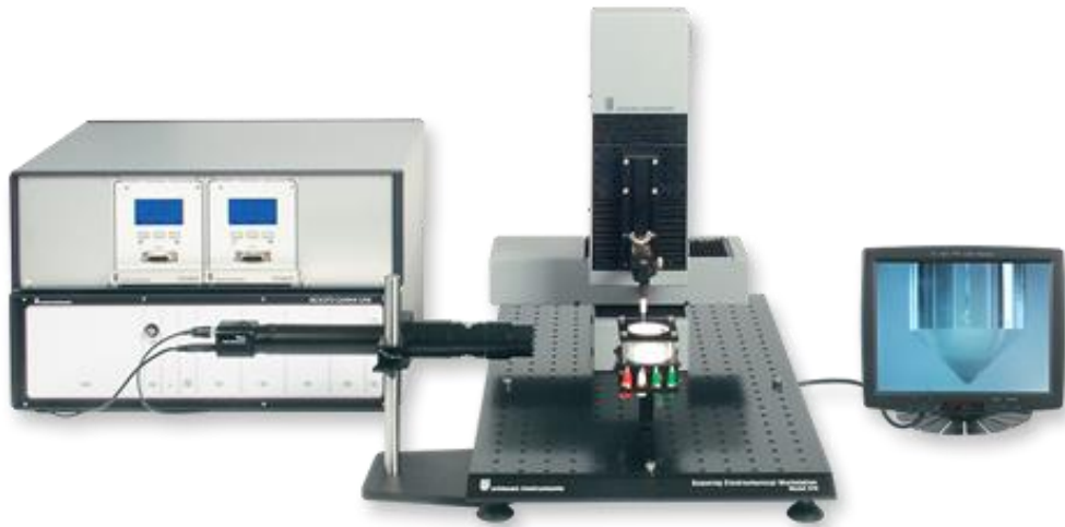
Рисунок 2.2 – Электрохимическая станция Scanning Electrochemical Workstation M370, «PAR» (USA) [334]
