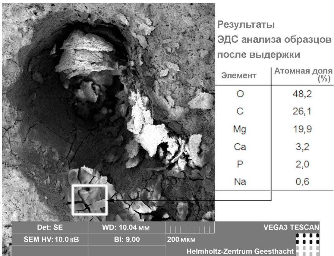
Рисунок 5.32 – СЭМ-изображение зоны питтинга образца с ПЭО-покрытием после 72 ч выдержки в МЕМ и ЭДС-анализ образовавшихся продуктов коррозии
