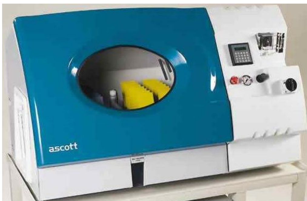
Рисунок 2.6 – Камера соляного тумана S120 «Ascott Analytical» (UK)
