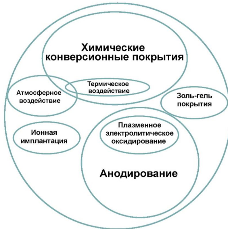
Рисунок 1.20 – Диаграмма, отражающая возможные способы защиты сплавов магния для практического применения в медицине [15]
