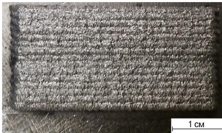
Рисунок 5.46 – Внешний вид образца магния, сформированного по DLD-технологии
