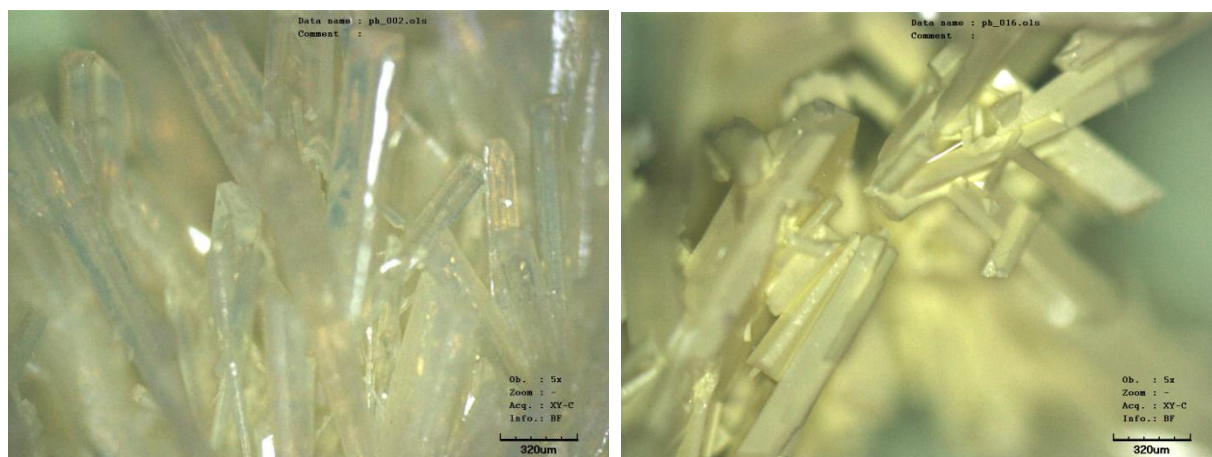
Рисунок 6.40 - Микрофотографии кристаллов \text{DBMBF}_2 , полученные на конфокальном лазерном сканирующем микроскопе LEXT OLS 3100: (а) - сольват только что вынутый из раствора, (б) - через два часа выветривания бензола
